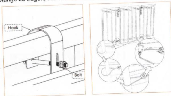
Befestigen Sie die Stange mit Stahlseilen.
