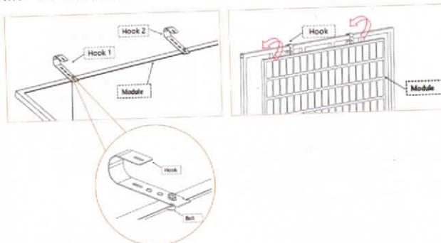
2. Verwenden Sie nach der Montage des Hakens M6 \* 80-mm-Schrauben, um das Solarpanel an der Oberseite der Stange zu befestigen, zerlegen Sie dann das Stahlkabel, um es über der Stange zu tragen, und montieren Sie dann das Stahlkabel wieder.
